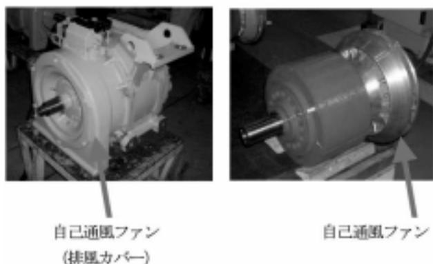
図5 同期電動機外観および回転子
