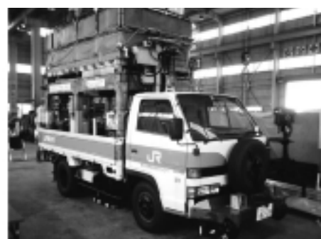
(a) 常温圧接専用車の外観
