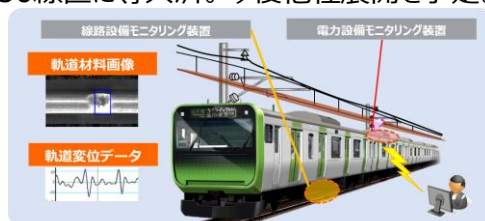
CBM（地上設備モニタリング）
