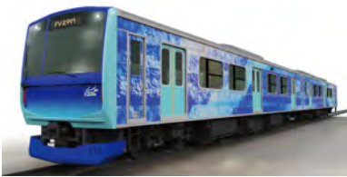
ハイブリッド車両（燃料電池）試験車両 FV-E991系（HYBARI）
