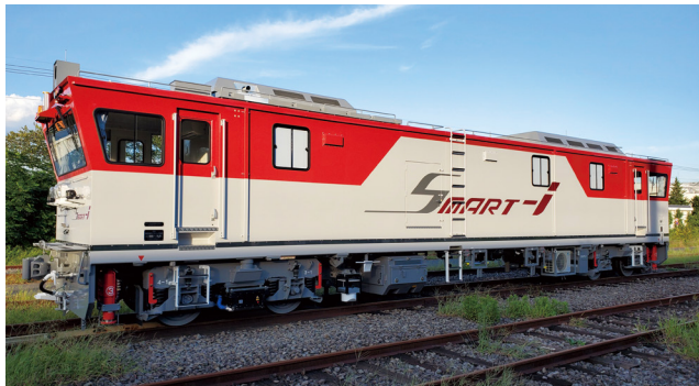
新幹線においても「新幹線線路設備モニタリング装置」を搭載した専用保守用車「SMART-i」を試験導入
