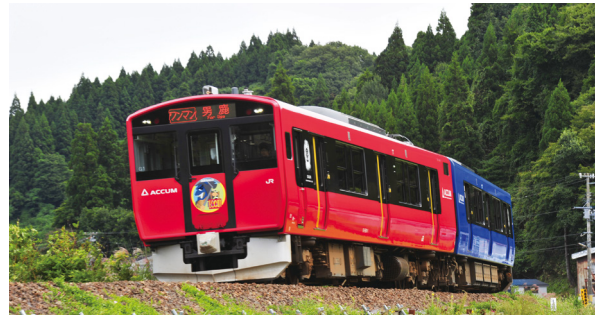
EV-E801系は交流電化区間と非電化区間を走行できる新型交流蓄電池電車
