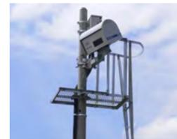
3次元レーザーダ式障害物検知装置
