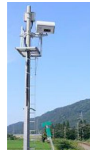
3次元レーザレーダ方式 (大型支障物検知装置)
