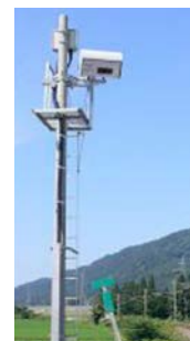
3次元レーザレーダ方式 (大型支障物検知装置)
