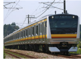
E233系 通勤・近郊での主力として活 躍するVVVFインバータ車両
