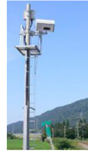
3次元レーザレーダ方式 (大型支障物検知装置)
