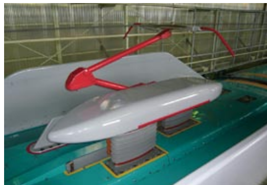
E5系では、低騒音型のパンタグラフを搭載
