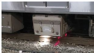
線路設備モニタリング
