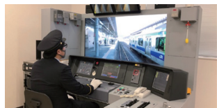
実映像を用いた臨場感ある乗務員訓練用シミュレータ
