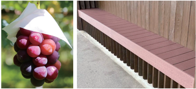
ワインパミスを活用した建築材料を使用したベンチ
