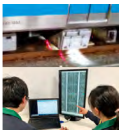
線路設備モニタリング
