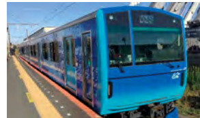
水素ハイブリッド電車「HYBARI」
