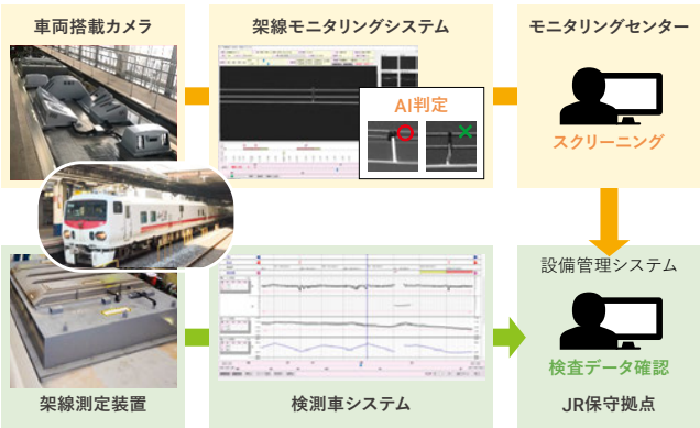
架線モニタリングによるメンテナンス業務の省力化
