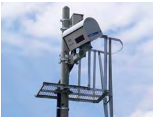
3次元レーザレーダ式障害物検知装置
