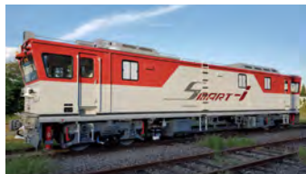
新幹線においても「新幹線線路設備モニタリング装置」を搭載した専用保守用車「SMART-i」を試験導入
