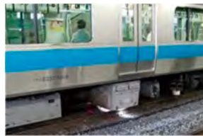
線路設備モニタリング装置(在来線)
