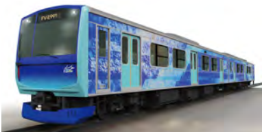
ハイブリッド車両（燃料電池）試験車両 FV-E991系（HYBARI）
