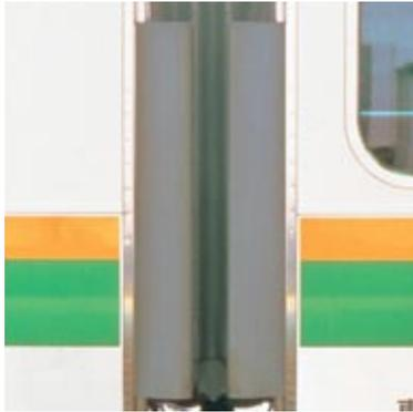
お客さまが、車両間のすき間に転落することを防止するために、車両間にゴム製幌を設置しています。
