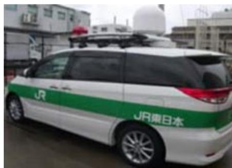
衛星通信設備搭載車
