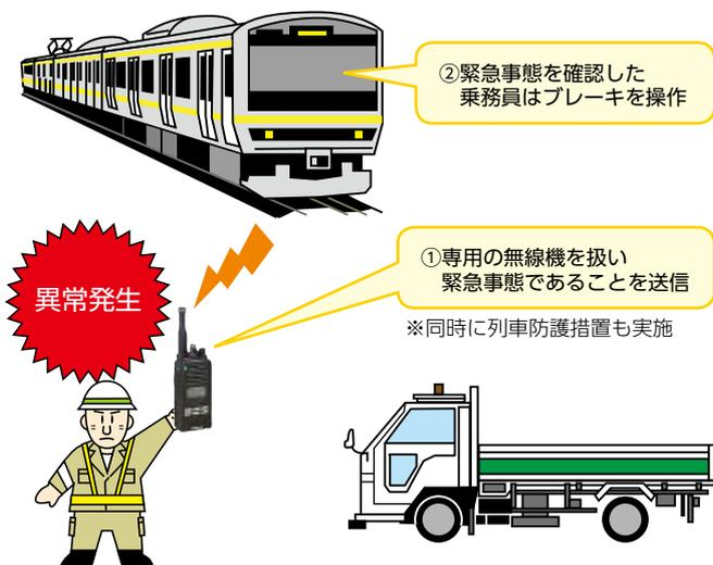
衝突防止支援無線システムは、異常が発生し列車等を急遽止めなければならない時に、専用の無線機端末を操作すると緊急事態の発生を付近の列車等に知らせるものです。全ての在来線列車等が対応しており、これが届いた運転士はいち早く列車等を止めます。
