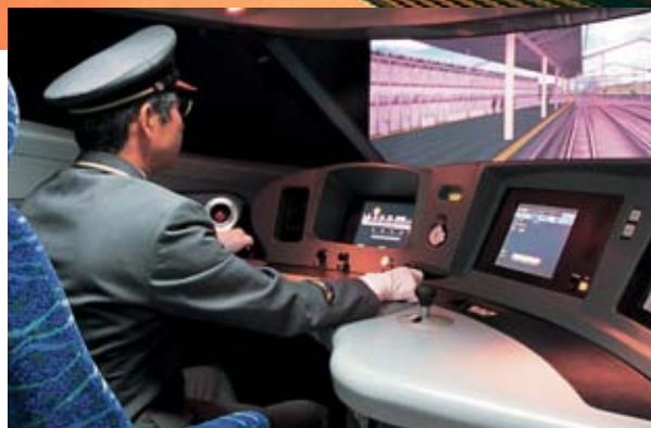
実車感覚で事故予防訓練を行う「新幹線運転士訓練用シミュレータ」
