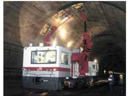
詳細かつ効率的に新幹線トンネルを検査する「トンネル覆工検査車」
