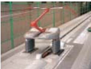
風切り音を低減することのできるシングルアームパンタグラフとがいし
