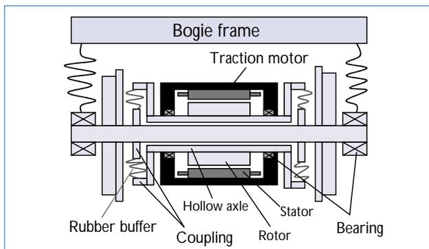
Fig. 4 Installing the DDM
