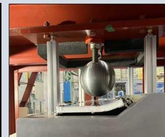
図6. 耐衝撃試験の様子
