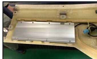
図2. 現行E8系新幹線電車のヒータ付台車カバー
