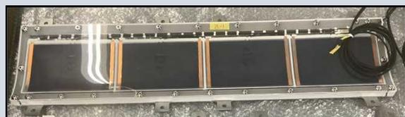
図3. 開発した面状ヒータユニットの外観
