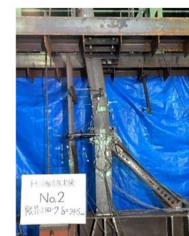
耐力試験によって在来溶接工法と同等の性能を確認！
