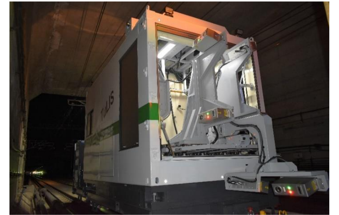
トンネル変状展開図作成の流れ(ひび割れ抽出) トンネル覆工表面撮影車による撮影状況
