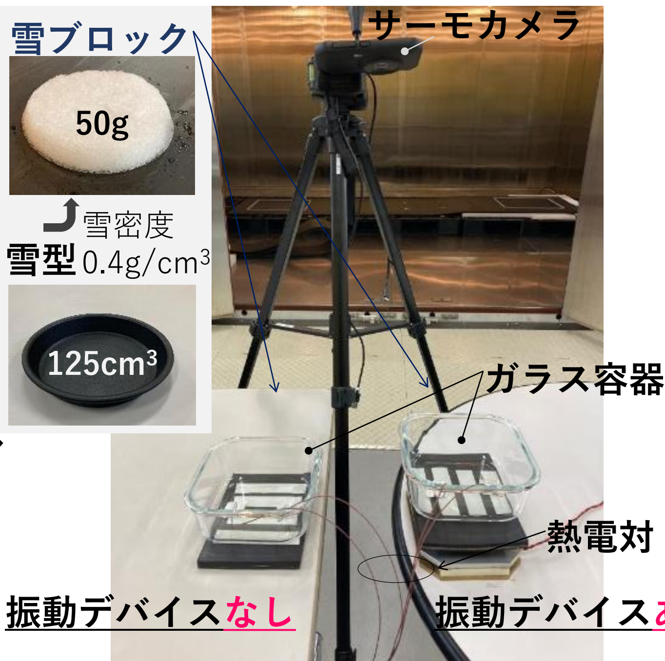
図5. 振動による融雪促進効果の検証方法
