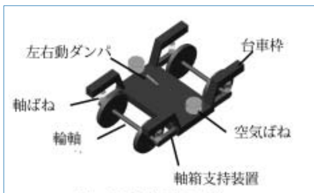
図1：209系用台車のモデル
