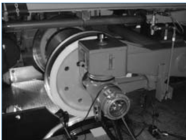
図22：台車試験装置での試験
