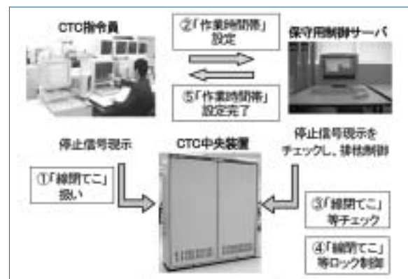
図6：作業区間への列車の進入防止方法
