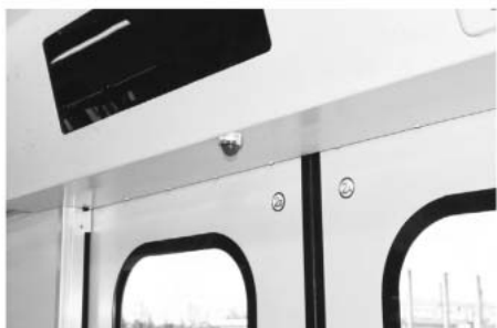
図4：AC Trainに設置した側引戸開閉表示灯
