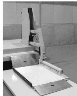
図3：試作した車椅子昇降装置の外観
