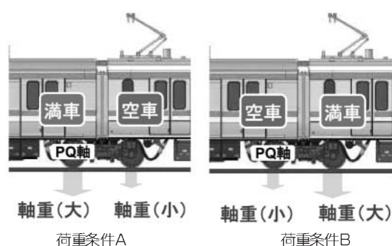
図13：前後偏荷重の設定条件
