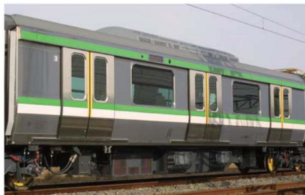
図6：ステンレス鋼によるダブルスキン車体
