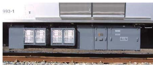
図10：自己診断・応急処置機能を持つ補助電源装置
