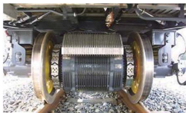
図7：直接駆動式主電動機（DDM）の外観
