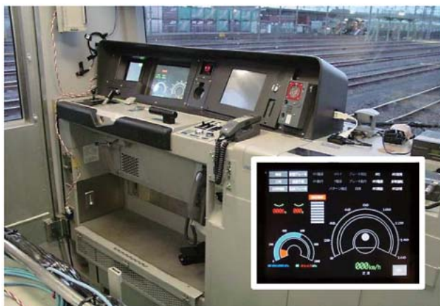
図11：AIMS(Advanced Train Information Management System)を使用した運転台モニタ装置
