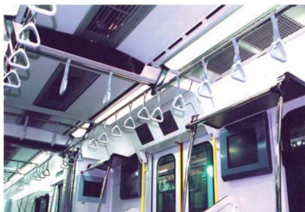
図8：車内の情報提供用LCD
