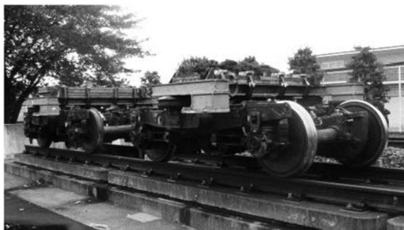
図1 試験台車の外観
