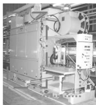
図2：床下機器清掃装置外観 (1点鎖線内は集塵装置) (点線枠内は集塵フード)
