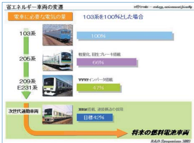
図 6：電車で必要な電気の量の変遷
