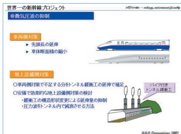
図28：微気圧波の抑制
