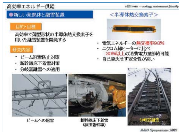
図22：新しい発熱体（半導体熱交換素子）
