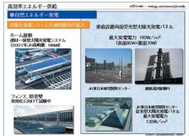
図17：太陽光発電システム
