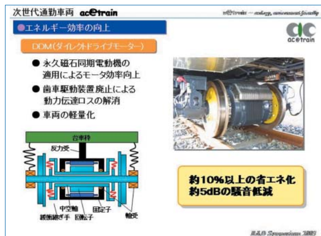
図5：DDM(ダイレクトドライブモーター)
