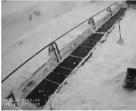
図5 開発した電気式マット融雪装置
