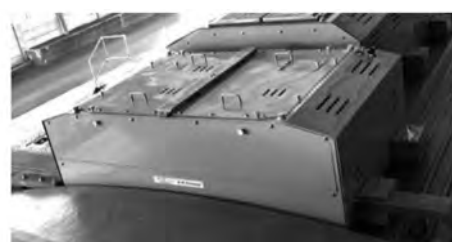
図7 屋根上配管ユニット (2号車)
