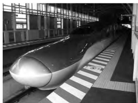
図3 アルミ車体のE5系新幹線の先頭形状
