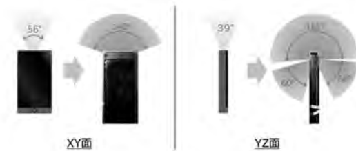
図5 ミリ波端末の受信角度(受信エリア)
