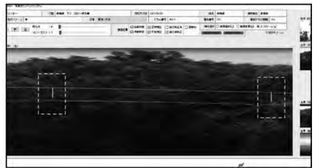
図14 AIの画像診断による不良箇所表示
