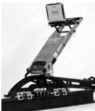
図9 渦電流探傷装置
