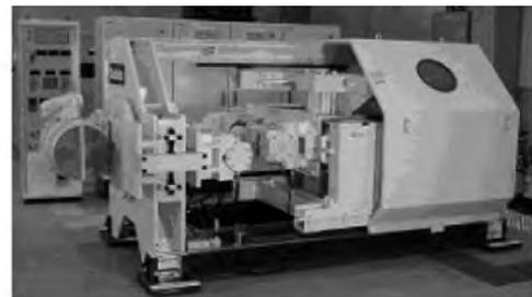
図5 車輪・レール転動試験装置
