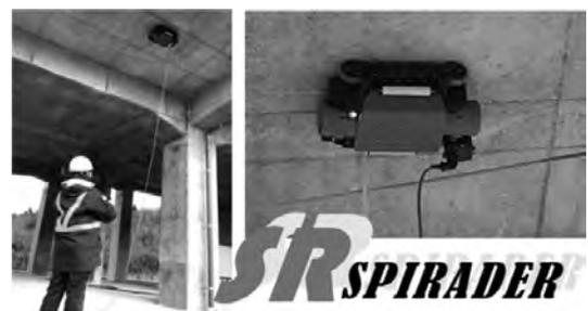
図5 鉄筋探査ロボット
