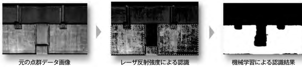
図11 レーザ反射強度と機械学習を組み合わせた認識結果 (補修材)
