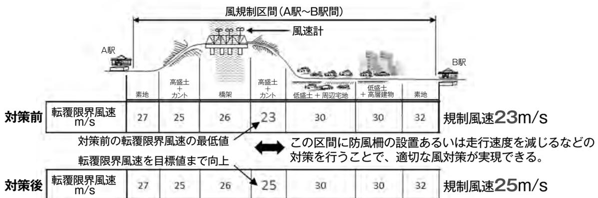
図3 総研詳細式に基づく風規制手法による対策実施と規制方法のイメージ
