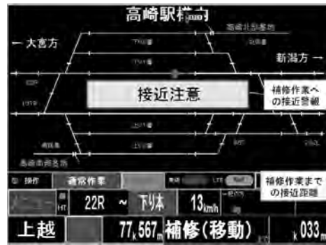
図6 補修作業員への接近警報
