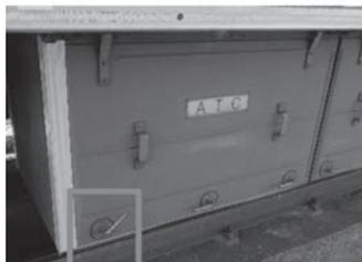
図9 機器箱点検フタ開閉ハンドルの角度を変えたときの差分距離値の変化
