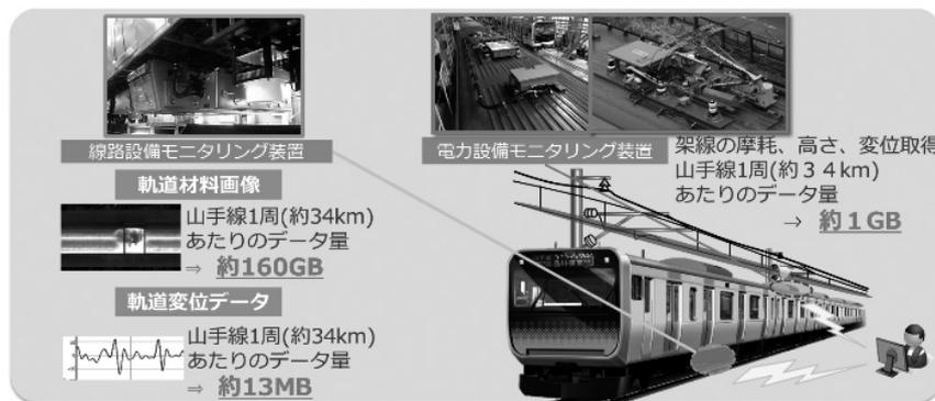
図7 E235系車上モニタリング装置
