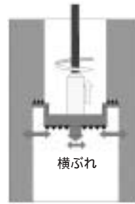
図14：横ぶれの状況
