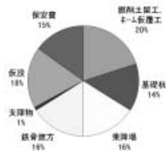
図2：人工地盤の建設コスト内訳
