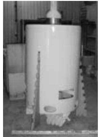
図16：改良した拡径削孔ビット
