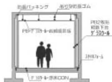
図1：従来の防振防音工法
