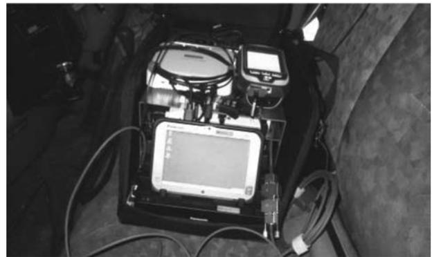
図6 車載装置の搭載状況 (軌陸車助手席)
