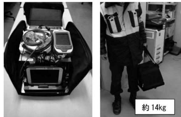
図4 試作した車載装置
