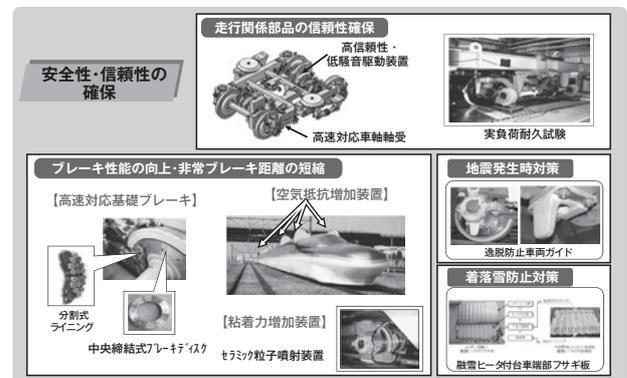
図7 主な技術開発の概要 (安全性・信頼性の確保)
