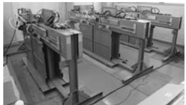
図12 改良型戸閉装置とINTEROSとの組み合わせ試験の様子 (定置/戸閉装置モックアップ部)
